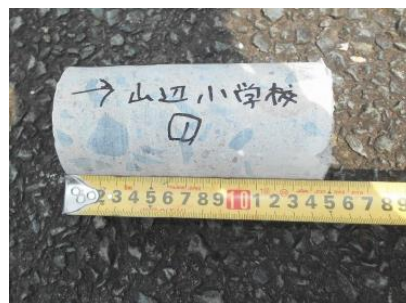
写真 5. 抜き取られたコア
