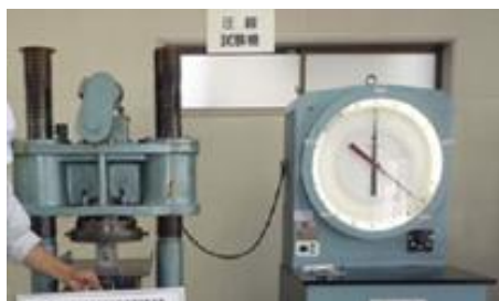
写真 7. コンクリート圧縮強度試験
