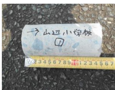
写真 9. 抜き取られたコア
